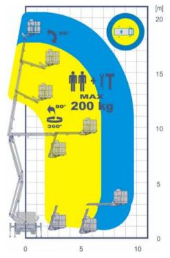
Arbeitshöhe max. 20,60m Plattformhöhe 18.60m max. Plattformgröße L/B 1,40/0,71m Tragkraft max. 200kg Seitl. Reichweite 9.50m Drehbereich nicht endlos 370° Arbeitskorb drehbar 160° Transportlänge 5,86m Transportbreite 2,10m Transporthöhe 2,77m Abstützbreite schmal 1.95m Abstützbreite breit 2.80m Eigengewicht 3500kg
